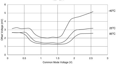
ANALOG COMPARATOR OFFSET VOLTAGE vs. COMMON MODE VOLTAGE  $_{\mbox{Vcc}\,=\,2.7\mbox{V}}$
