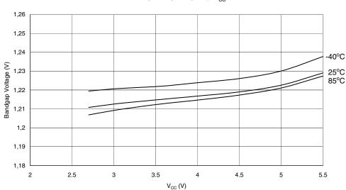
BANDGAP VOLTAGE vs. V<sub>CC</sub>
