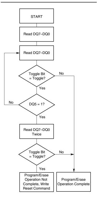
**Note:** The system should recheck the toggle bit even if DQ5 = "1" because the toggle bit may stop toggling as DQ5 changes to "1." See the subsections on DQ6 and DQ2 for more information.
